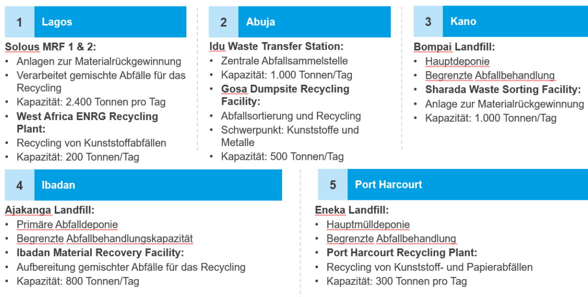
Abbildung 4 Kurzdarstellung der wichtigsten Deponien und Anlagen
