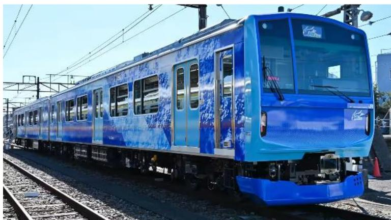
Abbildung 4: Der neue Wasserstoff-Hybridzug HYBARI
