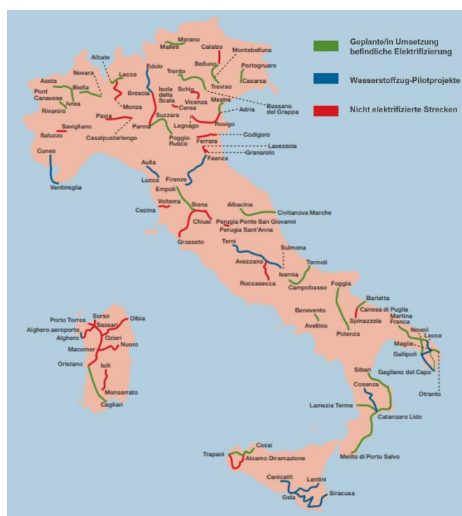
Abbildung 16: Übersicht über die Elektrifizierungen und die Wasserstoffzugstrecken im italienischen Eisenbahnnetz. Quelle: Legambiente (2024)
