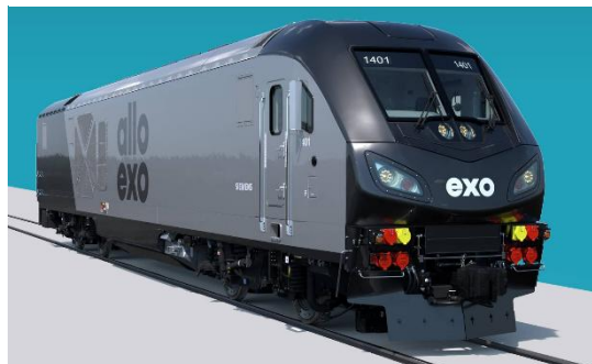
Abbildung 3: Siemens-Lokomotive vom Typ "Charger"
