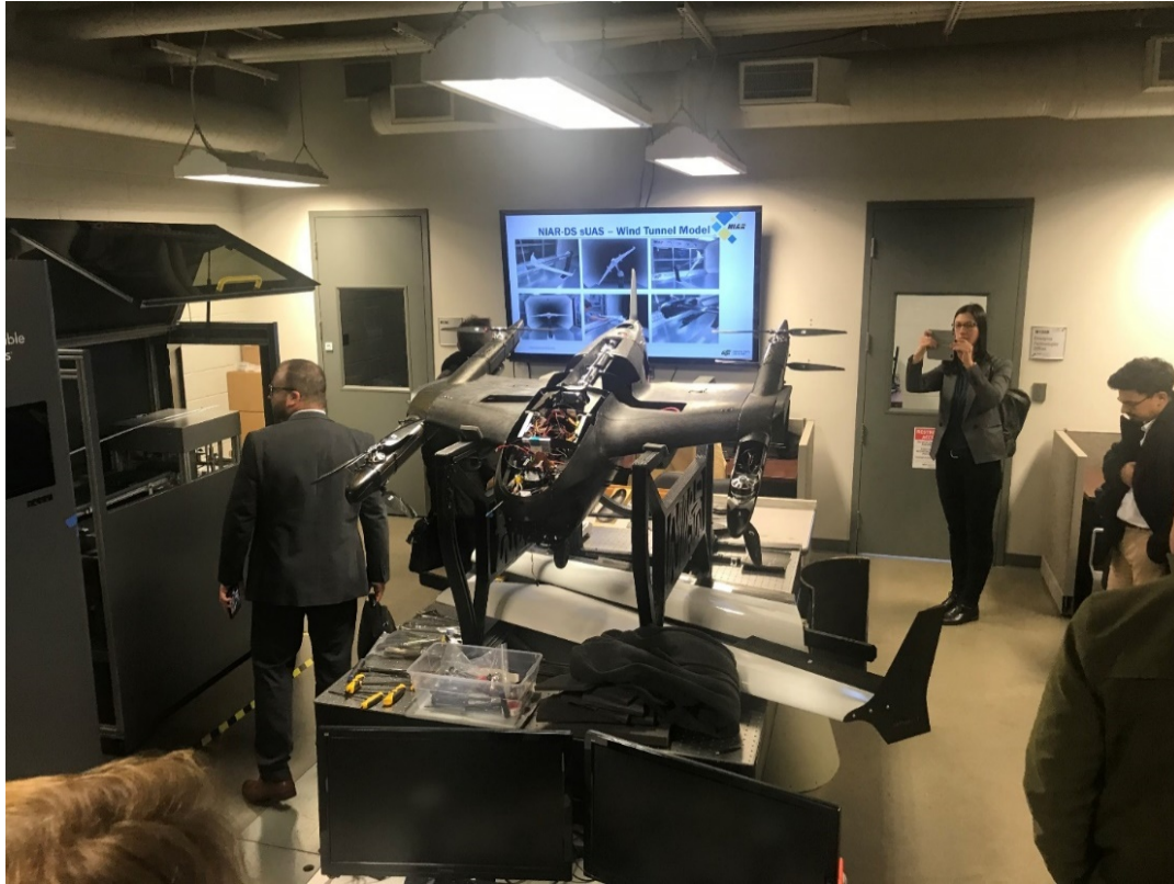
Unbemanntes Kohlefaser-Luftfahrzeug, entwickelt und gebaut am National Institute for Aviation Research in Wichita
