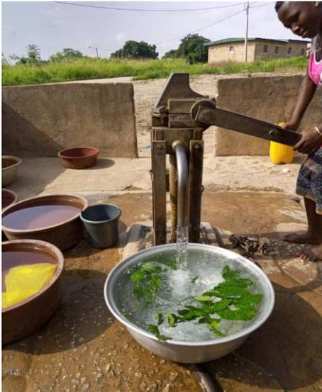
Abbildung 12:ABI-Vergnet menschliche Traktionspumpe
